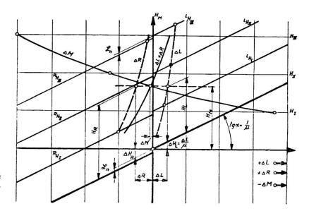
**Abb. 5.** Graphische Ermittlung des Horizontalzuges.
