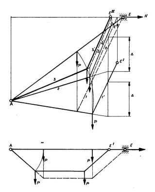
parallel nach 2' verschoben, wodurch der Endpunkt nach E<sup>II</sup> kommt. Das Verfahren wird nun solange fortgesetzt, bis E genügend genau in der richtigen Höhe liegt. Sind System und Belastung symmetrisch, so ist von vornherein eine Erfüllung der Höhenbedingung möglich. Der erste Iterationsgang gibt also bereits das endgültige Ergebnis.
