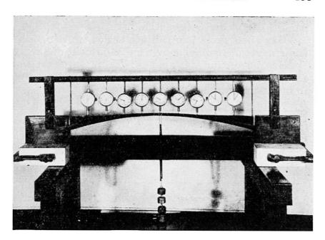
**Fig. 3.** Disposition utilisée pour la mesure des flèches.
