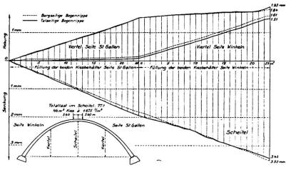
Abb. 12. Messungsergebnisse des belasteten Bogens.
