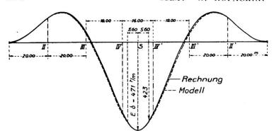
**Abb. 5.** Vergleich zwischen Rechnung und Messung.
