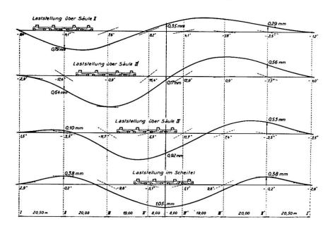
**Abb.** 14. Probebelastung der fertigen Brücke.
