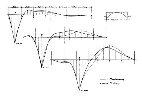
Abb. 9. Einflusslinien für Biegungsmomente in einigen Schnitten S des Fahrbahnträgers.
