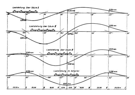
**Abb. 14.** Probebelastung der fertigen Brücke.
