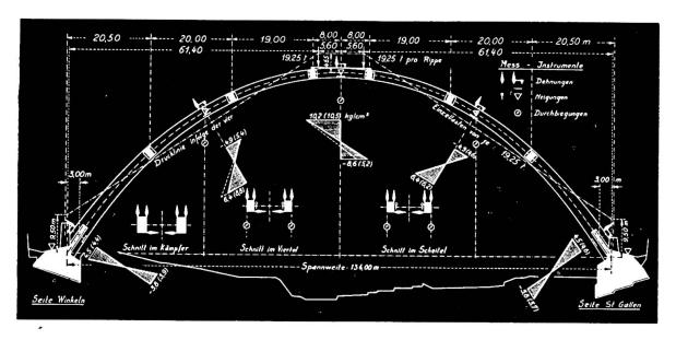
Abb. 13. Berechnung der Spannungen im Bogen.
