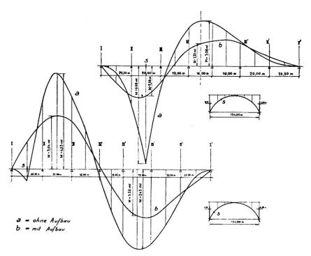
**Abb. 8.** Einflusslinien für Biegungsmomente in den Schnitten S des Bogens mit oder ohne Aufbau.
