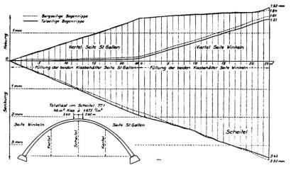
Abb. 12. Messungsergebnisse des belasteten Bogens.
