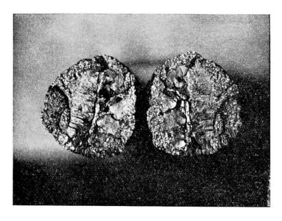
Fig. 4. Rupture par fatigue d'une soudure présentant un défaut d'angle.
