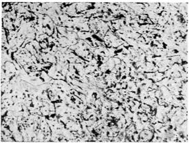
Fig. 7 et 8. Zone non surchauffée (structure perlite-ferrite normale) et zone surchauffée (structure perlite-ferrite à grains fortement grossis) d'un joint soudé par résistance.
