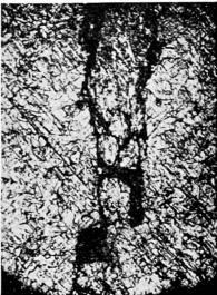
Fig. 10. Coupe longitudinale et macrographie d'un joint soudé par étincelage.
