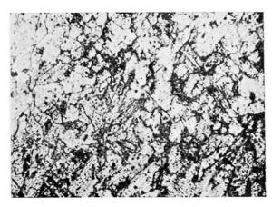
Fig. 12 et 13. Zones non surchauffée à proximité immédiate du joint (structure ferrite-perlite normale avec nombreuses impuretés) et surchauffée (structure ferrite-perlite à grains assez gros avec quelques impuretés) d'un joint soudé par étincelage.
