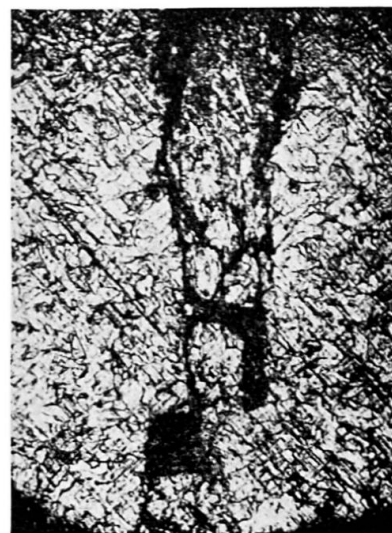
Fig. 11. Collage dans la zone de jonction d'un joint soudé par étincelage.
