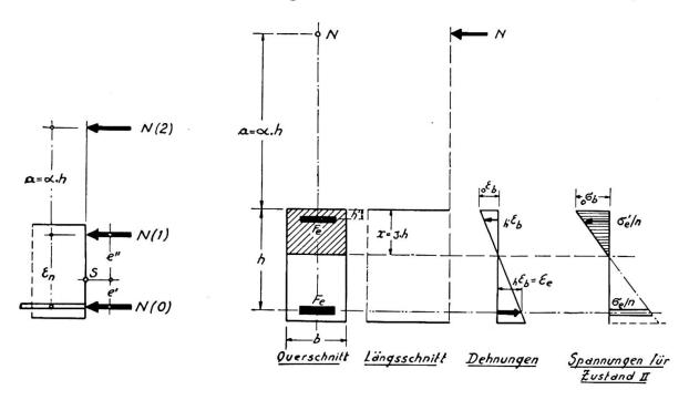
**Abb. 1 und 2.** Bei Wirkung der Vorspannung allein greift die Druckkraft im unteren Kernpunkt an (0). Bei Wirkung des zulässigen Biegemomentes wandert die Druckkraft in den oberen Kernpunkt (1). Bei weiterer Steigerung des Momentes tritt die Kraft aus dem Querschnitt heraus (2). Der Abstand a der Kraft N von der Druckkante beim Bruch ist ein Mass für die Bruchsicherheit.
