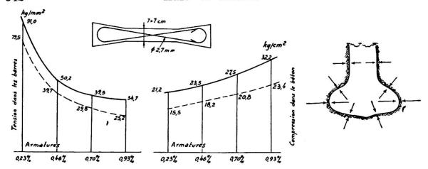
Fig. 17. Tensions dans les armatures et dans le béton des prismes d'essai.
