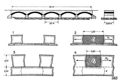
Fig. 13. Ordre de bétonnage du viaduc de Laroche.
