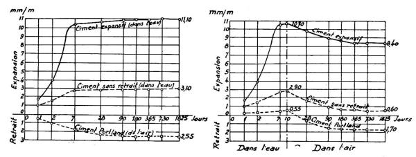
Fig. 1 et 2. Retrait et expansion des ciments.
