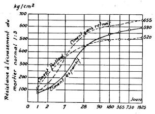
Fig. 4. Résistance des cubes d'essai en fonction du temps.
