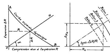
Fig. 20 et 21. Courbes d'expansion dynamique de divers bétons.
