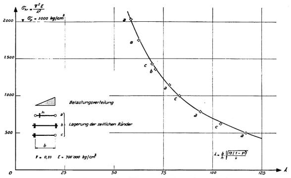
Abb. 6. Theoretische Werte und Versuchsergebnisse.
