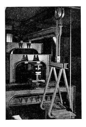
**Abb. 1.** Hebelmaschine von 25 t Druckkraft.
