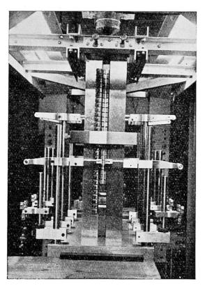
**Abb. 5.** Gesamtübersicht der Beul- und Messvorrichtungen für eine Platte  $16 \times 48$  cm (Seitenansicht).
