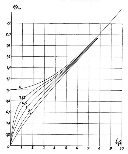
Fig. 2. Variation de la flèche relative de voilement  $\frac{f}{\gamma h}$  en fonction de la tension relative  $\frac{p}{p_{\rm cr}}$  pour diverses valeurs de la flèche initiale relative  $\frac{f_0}{\gamma h}$ .
