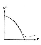
Fig. 3 (à gauche). Plaque circulaire encastrée soumise à des forces radiales compression.
