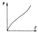
Fig. 1. Allure générale de la courbe de la flèche transversale en fonction de la charge.
