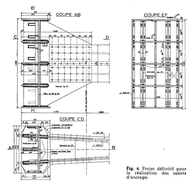
Il frappe encore par la présence de nombreuses intersections de cordons de fortes dimensions. L'épaisseur élevée (50 mm) des plaques transmettant la pression au béton, la fixation de ces plaques, par ailleurs de dimensions réduites, au moyen de liaisons en bout continues dont le retrait est empêché, sont d'autres éléments, tous défavorables à la réussite de l'exécution d'une pièce aussi vitale dans le fonctionnement de l'ouvrage.
