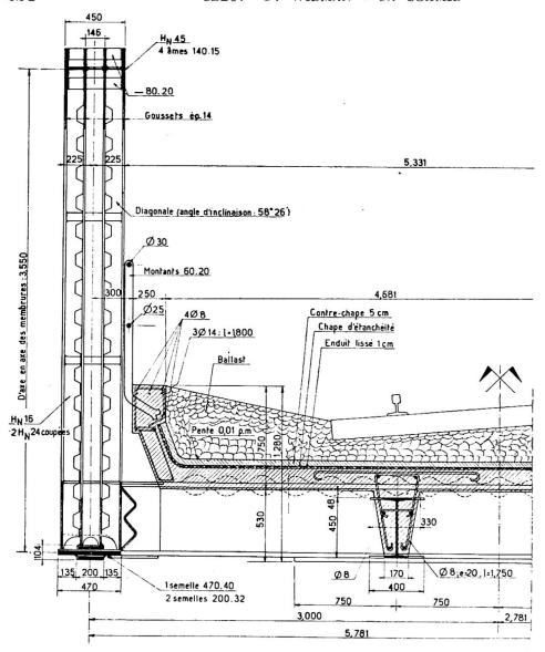
Fig. 3. Elévation du pont des Joncherolles. (Demi-coupe longitudinale.)
