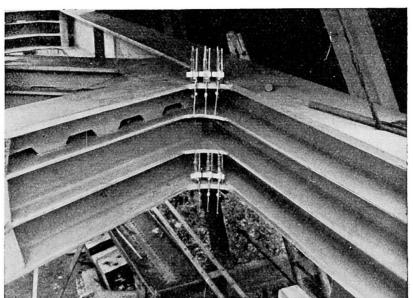
Fig. 9. Essai en atelier. Tensomètres fixés sur les goussets.
