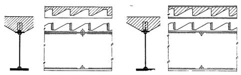
Fig. 7. Fixation des chevilles par cordons longitudinaux.
