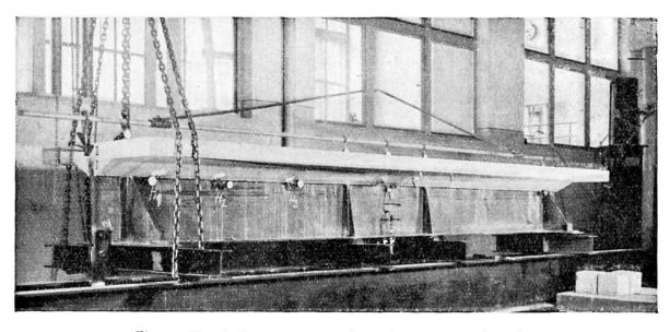
Fig. 9. Essai d'une poutre chargée aux extrémités.
