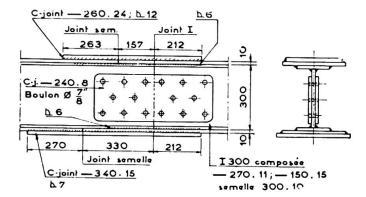
Fig. 11. Réparation d'une ossature : exécution d'un joint de poutre à retrait empêché.
