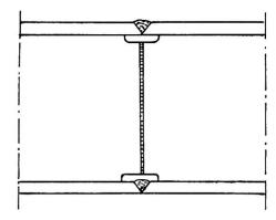
L'emplacement, le dimensionnement et la forme des joints soudés sont autant d'éléments à déterminer en fonction de la sollicitation de service de l'ouvrage, mais surtout en fonction de la possibilité d'une bonne exécution des joints et de la réduc-
