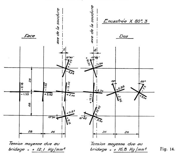
tion des éprouvettes; cependant, dans les régions suffisamment éloignées du joint où les déformations sont inférieures à celles correspondant à la limite élastique, la mesure de ces déformations suivant trois directions au moins, peut conduire à la détermination des tensions.
