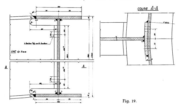
pour les neuf joints exécutés, c'est-à-dire que les deux lèvres de l'âme étaient presque jointives accusant un vide apprécié par les plus fines lames d'un canif à épaisseurs;
