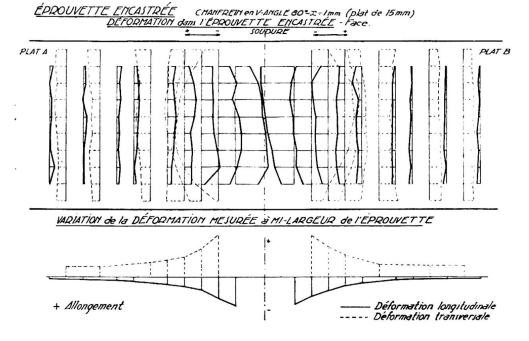
libérées sont nettement supérieures et peuvent être égales au double, même au triple de celles des éprouvettes libres pour les soudures épaisses en V ou en X.
