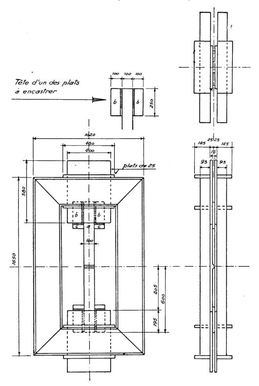
Fig. 3. Cadre rigide pour l'encastrement des éprouvettes.
