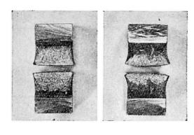
Fig. 17. Barreau rompu dans l'essai de résilience U.F.; on notera dans l'essai à droite la faille transversale due à un doublage.
