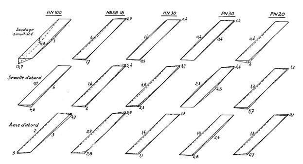
Fig. 15. Images de la déformation de l'âme.
