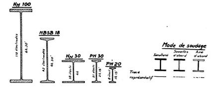
Fig. 1. Poutrelles expérimentales utilisées au cours des essais. Le tracé représentatif se rapporte aux figures 3 à 11.
