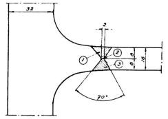
**Abb. 4.** Raupenfolge in einer X-Naht zwischen Stegblech und Gurtplatte.
