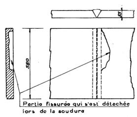
Fig. 6. Fissuration d'un large plat à la suite de l'exécution d'une soudure bout-à-bout.
