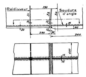
Facteurs probables: 1. passage trop brutal d'une épaisseur à l'autre, d'où concentration locale des tensions; 2. fixation des raidisseurs à l'âme et aux semelles ayant provoqué des tensions résiduelles: 3. défaut probable dans les soudures d'angle, soumises à des tensions polyaxées.
