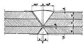
Fig. 13. Coupe des cordons de soudure de la partie au droit des cornières.
