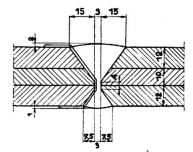
Fig. 17, 18 et 19. Coupe du joint de semelle au droit de la semelle seule, des semelles et ailes de cornières, de l'âme et aile de cornière.
