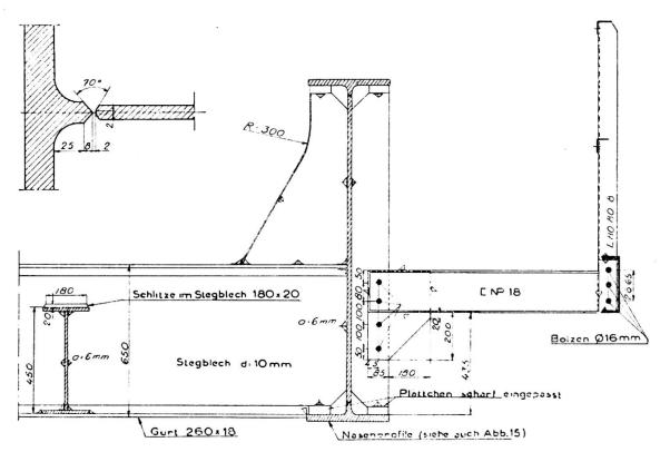
Abb. 15 und 16. Hauptträger und Anschluss der Querträger.
