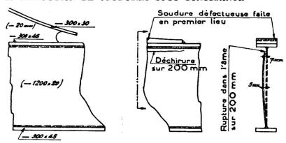
Fig. 9. Rupture d'une membrure inférieure de pont.
