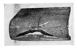
Fig. 15 et 16. Résultats d'essais de pliage d'éprouvettes comportant une rainure et une entaille.
