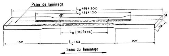
Fig. 8. Forme et dimensions de l'éprouvette de l'essai de traction avec cordons de soudure superficiels longitudinaux.
