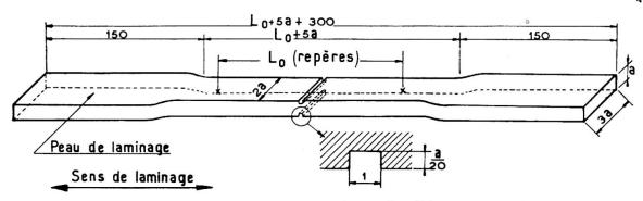
Fig. 5. Forme et dimensions de l'éprouvette de l'essai de traction avec entaille préalable.
