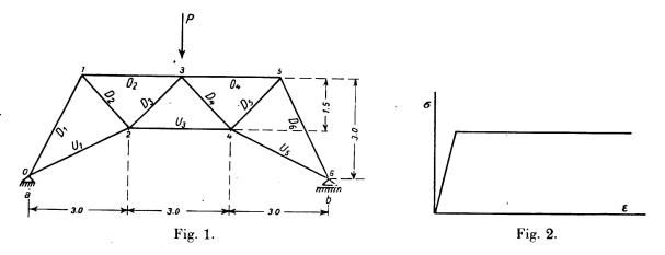
Unter Berücksichtigung eines Nietabzuges für Lochdurchmesser 20 mm in den Zugstäben, unter Zugrundelegung der Streckgrenze mit  $\sigma_s = 2.4 \text{ t/cm}^2$  und der Knickspannung  $\sigma_k$  nach den Vorschriften der Deutschen Reichsbahn betragen die Grenzstabkräfte, mit denen die Tragfähigkeit des Einzelstabes als erschöpft angesehen werden soll,
