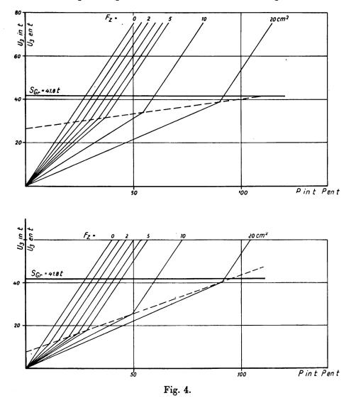
Stabkraft U<sub>3</sub> in Abhängigkeit von der Belastung P und vom Zugbandquerschnitt F<sub>z</sub>.
