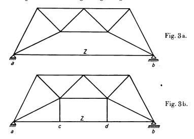
Werden die beiden Lagerpunkte a und b nun durch ein Zugband Z verbunden (Fig. 3), so wird damit das Kräftespiel und das Tragvermögen grundsätzlich geändert. Nach den Regeln der Statik für die Berechnung statisch unbestimmter Systeme wird die Stabkraft im Zugband, wenn  $S_a$  die Stabkräfte aus  $X_a = -1$  am statisch bestimmten System sind,  $Z = X_a = \delta \, ao/\delta \, aa$ . Der Zähler wird
