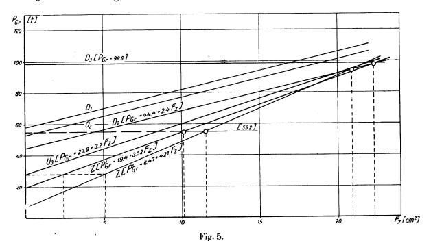
Grenzlasten PGr in Abhängigkeit vom Zugbandquerschnitt Fz.
