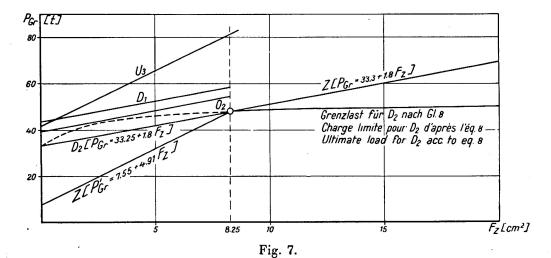
P=48,05t ergibt bei  $F_z=8,25~\rm cm^2$  im Zugband und in  $D_2$  gleichzeitig die Streckspannung. Für  $F_z<8,25~\rm cm^2$  ist die Tragfähigkeit begrenzt durch die letzte der Gl. 4; für  $F_z>8,25~\rm cm^2$  verlieren die Gl. 7 ihre Gültigkeit, da  $D_2$  nunmehr der höchstbeanspruchte Stab ist und als solcher zuerst gestreckt wird. Die Grenzlast für  $D_2$  als Funktion von  $F_z$  wird aus der Stabkraft im unbestimmten System
