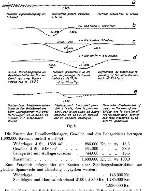
Da die Kosten der Fahrbahnkonstruktion in beiden Fällen nahezu gleich sind, ist der Beton in diesem Falle dem Stahle wirtschaftlich bedeutend überlegen.
