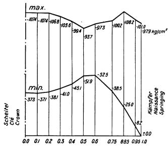
Verteilung der max und min Spannungen im Gewölbe. (Exceptionnaller Belastungsfall)
