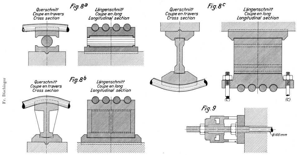
Fig. 8. 8 a. Rollenlager für die Lagerung der Hängegurte.
