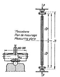
l = Stablänge-Longueur de la barre-Length of test piece l<sub>K</sub> = Knicklänge-Longueur de flambage-Buckling length
