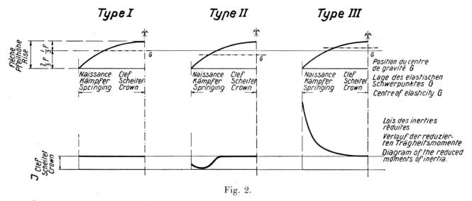
Lage der Hauptträgheitsachsen welche durch den Schwerpunkt G der mittleren Faser gehen; Verlauf der reduzierten Trägheitsmomente für die Bogentypen I, II und III.
