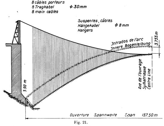
La Caille-Brücke, 137,50 m Spannweite. Aufstellung des Lehrgerüstes mit Tragkabeln.
