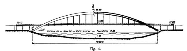
Brücke bei La Roche-Guyon. Aufriß und Längsschnitt.
