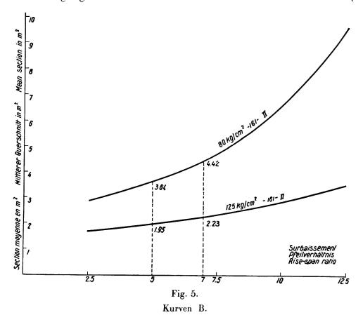
Änderung des mittleren Querschnittes in Funktion des Pfeilverhältnisses für Bogentyp II von 161,00 m Stützweite und für Beanspruchungen von 80 kg/cm<sup>2</sup> und 125 kg/cm<sup>2</sup>.
