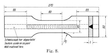
Tensile test bar.
