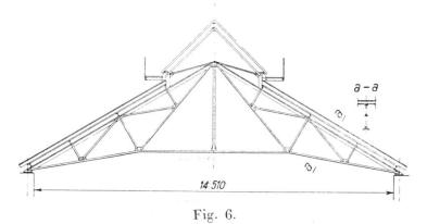
Dachkonstruktion für das Kraftwerk Engertstraße der Städt. Elektrizitätswerke in Wien.
