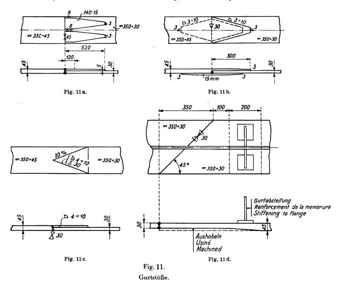
der dicken Lamelle um die Stärke der dünnen Lamelle und Anschluß der Überlappung durch Kehlnähte und Quer-V-Naht, gesichert durch eine Decklasche, wegen der teuern Bearbeitung und der zu erwartenden erheblichen einseitigen Schrumpfung der V-Naht nicht bewährt. Mit Erfolg wird der weiter dargestellte
