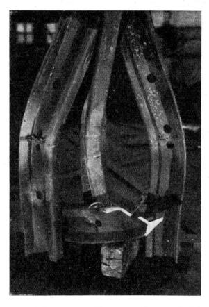
Fig. 6. Kaltgebogene geschweißte Schienen
