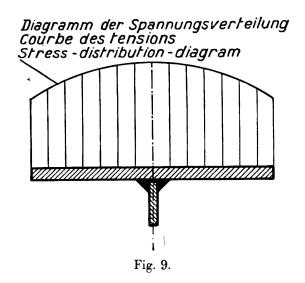
Die Beanspruchung des Steges der Anschlußbleche ist reichlich verwickelt. Versuche haben ergeben, daß dünne Stege mit mehreren radialen Aussteifungen der Sitz von bedeutenden Restspannungen sind, die als Folge des Schrumpfens auftreten. Die Verwendung dickerer Stege ohne Versteifungen ist daher vorzuziehen.
