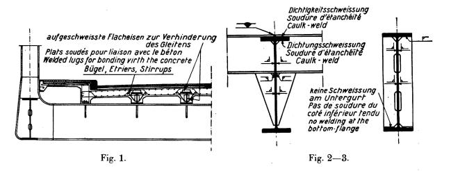
Die Querträger bestehen aus Differdinger-Profilen. Bei sehr breiten Brücken ohne oberen Windverband ist man jedoch manchmal gezwungen, zusammengesetzte Blechträger zu verwenden. Es handelt sich alsdann um vollwandige Träger, mit dünnen und hohen Stegblechen. Bei der Schweißung der Versteifungen sind innere Spannungen, die den Bruch des Steges verursachen könnten, zu vermeiden. Fig. 3 zeigt eine Ausführungsart der Stegversteifung.
