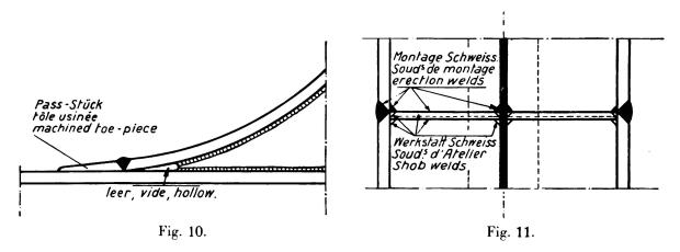
elastischen Linie. Es muß aber die Möglichkeit des Transports mit der Eisenbahn berücksichtigt werden. Deshalb sind für die Mittelstreben zwei Montagenähte vorgesehen, die im prismatischen Teil außerhalb der Anschlußkrümmungen angebracht sind. Die Maße der Streben und ihrer Stoßteile sind reichlich bemessen, weil hier die Beanspruchungen infolge Verkehrslast ihr Vorzeichen ändern können; es sind die am meisten beanspruchten Teile.
