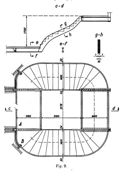
Gemäß den architektonischen Anforderungen sind hier Querschnitte 1. von einer I-Form und 2. von einer aus drei Blechen zusammengesetzten rechteckigen Form, welche miteinander durch Außen- und Schlitznähte verbunden sind. Die Auskrümmung einer aus einem dicken Blech bestehenden Wange in senkrechter und wagrechter Fläche wäre andersartig unmöglich.
