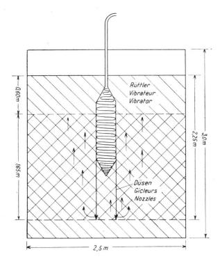
Fig. 15. Essais de compacification par vibration interne. Tassement à 74 % du remblais.
