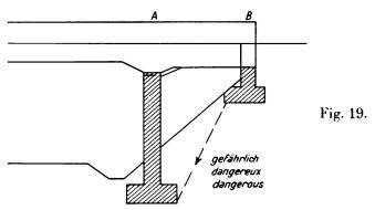
4º Dans le calcul des culées d'un pont il faudrait tenir compte du procédé de tassement artificiel projeté. Il faut être très prudent car un damage très
