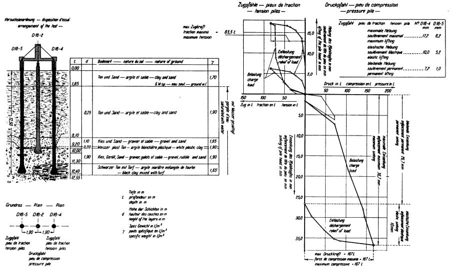
Fig. 7. Résultats de l'essai des pieux au Quai d'Orsay, Paris.
