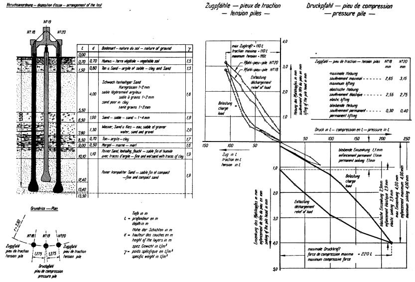
Fig. 6. Résultats de l'essai des pieux à St. Germain.
