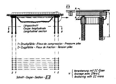
Fig. 8. Pont à poutres avec des pieux de compression et traction.
