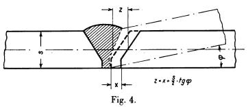
$x = Parallel querschrumpfung \quad \phi = Winkelschrumpfung \quad z = Gesamt querschrumpfung$   $Zerlegung \ der \ Querschrumpfung.$
