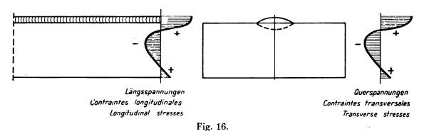
Längs- und Querspannungsanordnung beim Aufschweißen einer Raupe.
