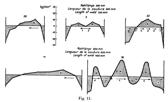
Werkstoff: St. 37. Plattendicke: 12 mm. Schweißverfahren: Lichtbogenschweißung. Schweißdrähte: Seelendrähte Böhler-Elite. Zahl der Lagen: 3.
