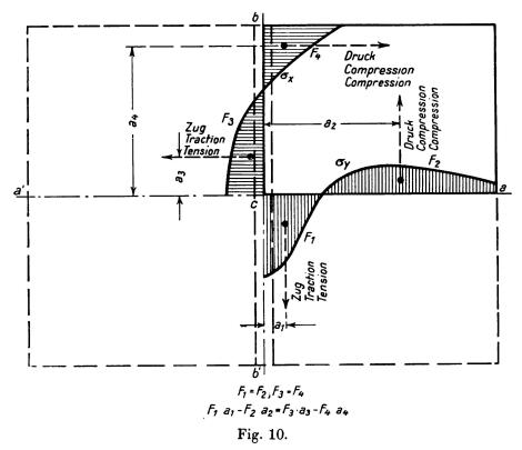
Zusammenhang zwischen Längs- und Querspannungen auf Grund des inneren Gleichgewichts.
