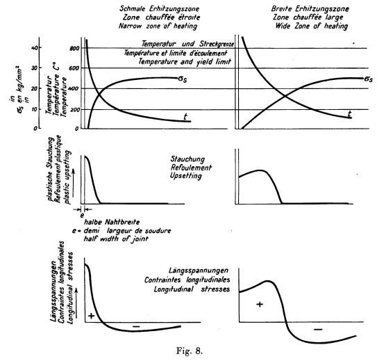
Temperatur-Stauchungs- und Spannungsverhältnisse bei schmalen und breiten Erhitzungszonen.
