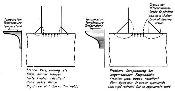
Fig. 21. Verspannungswirkung bei Kehlnähten.
