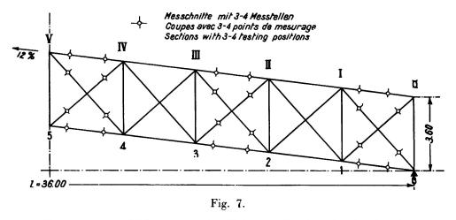
Trägernetz und Meßorte der schweißeisernen Brücken der Brüniglinie.
