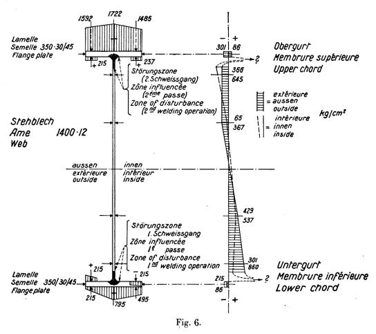
Messung von Schrumpfspannungen bei einer Vollwandbrücke der Linie Beinwil-Reinach. (Ergebnisse in einem Schnitt).
