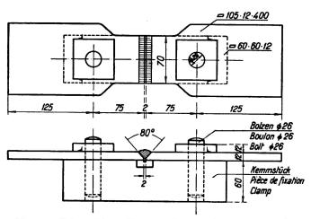
Fig. 6. Disposition d'un essai pour le mesurage des contraintes de retrait.
