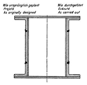
Fig. 1. Section de poutre transversale.
