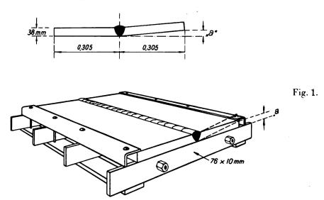
1º La fixation des éléments à assembler n'a pas besoin d'être absolument rigide pour être effective.
