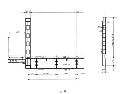
et que l'on a resoudés en déplaçant les deux pièces (fig. 6). Le tablier est en profilés laminés du type Alpha, recouverts d'une dalle de béton armé.
