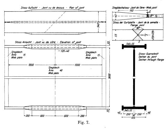
représenté à la fig. 7 des poutres à âme pleine du pont sur le Strelasund de la digue de Rügen. Il s'agit d'une poutre continue soudée reposant sur 6 appuis et dont les ouvertures ont chacune 54 m. Des mensurations exactes du Laboratoire d'essai des matériaux de Dahlem ont permis de fixer une suite du soudage telle que la membrure la plus fortement sollicitée à la traction par le poids propre et
