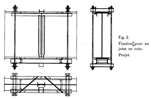
L'application de ce procédé aux semelles épaisses des membrures de pont a montré par contre que l'effet de la fixation interne a dépassé notre attente lors de l'exécution de soudures en forme de tulipe. Lorsque la soudure est
