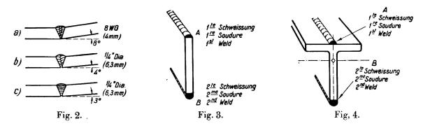
Un nouvel essai, avec dispositif de fixation, a donné une distorsion angulaire moyenne de 1° 11' seulement.
