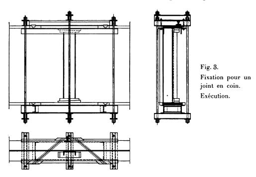
aux <sup>2</sup>/<sub>3</sub> effectuée, il se produit un très fort retrait angulaire contre lequel il faut lutter par un agrafage toujours plus fort des pièces à assembler. La fig. 2 donne un projet de fixation; la fig. 3 montre la rigidité qu'il a fallu donner à cette fixation pour lutter contre le retrait angulaire. Dans les poutres en acier St. 37
