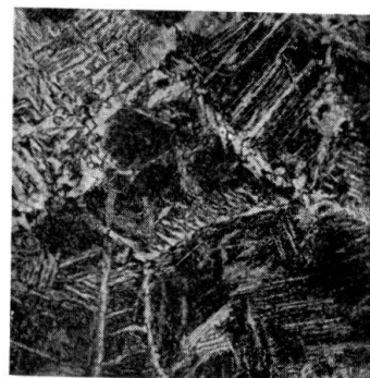
Préchauffé, aucune formation de martensite.
