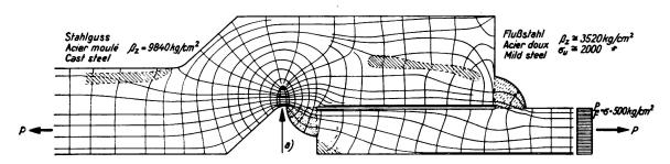
a) Contrainte d'après Navier-Hooke, calculée  $\frac{P}{F}+\frac{M}{W}$ :  $\sigma_{max}=2.8~\sigma=1400~kg/cm^2$ Résistance par rapport à l'origine de l'assemblage:  $\sigma_{u}\cong 500~kg/cm^2$ Pointe de tension au fond de l'entaille, optique:  $\sigma_{max}=5~\sigma=2500~kg/cm^2$ .
