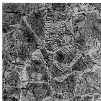
Structure thermiquement modifiée, ferrite et sorbite. Zone de transition.
