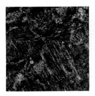
Température: — 10° C. Martensite avec traces de trostite trempée.
