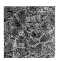
Structure thermiquement modifiée, ferrite et sorbite. Zone de transition.
