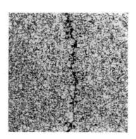
Structure à granulation transformée, fine et normalisée, avec fissure microscopique. Métal d'apport.
