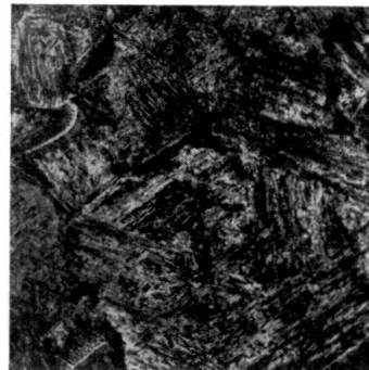
Température: 50^{\circ}\text{C} . Martensite, un peu de troostite, traces de ferrite.
