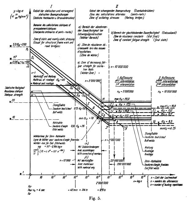
Les zones de la ligne des tensions-temps et de la ligne de Wöhler pour les assemblages de poutres (représentation logarithmique).
