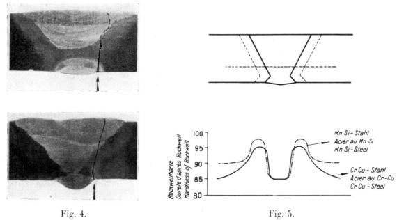
Amorce de rupture par fatigue au bord de la reprise à l'envers.
