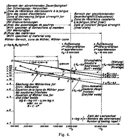
Zone de résistance décroissante à la fatigue (zone de Wöhler) de la ligne des tensionstemps (représentation logarithmique) pour les assemblages de poutres rivés et soudés.
