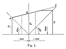
de l'alternance complète, choisie sur la base des données expérimentales. On a ainsi en B: min. = 0 et l'ordonnée  $S_0$  représente la contrainte à admettre dans le cas de la pulsation à partir de zéro.
