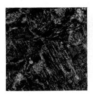
Température: — 10° C. Martensite avec traces de trostite trempée.
