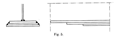
vue constructif parce que seule la semelle intérieure du paquet est fixée à l'âme, parce que la liaison de larges tôles par des soudures d'angles latérales est insuffisante et parce que les semelles se gondoleront lors de l'exécution des soudures d'angle, ce qui augmente le danger de voilement dans la zone comprimée. Ces inconvénients sont réduits lorsque l'on prend des semelles d'épaisseurs différentes reliées par des soudures bout à bout avec transition douce (fig. 6). L'épaississe-
