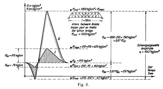
Le principe de l'amplitude et de la sécurité statique dans les assemblages des ponts-rails.
