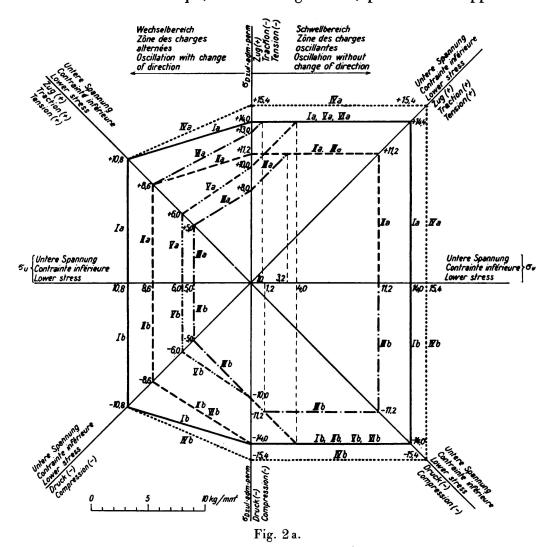
Diagramme des contraintes admissibles  $\sigma_{Dadm}$  dans le cas des ponts soudés en acier St. 37.
