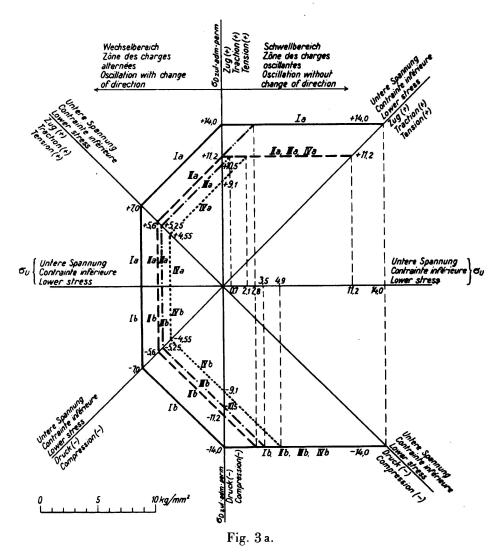
Diagramme des contraintes admissibles opadm dans le cas des ponts soudés en acier St. 37.
