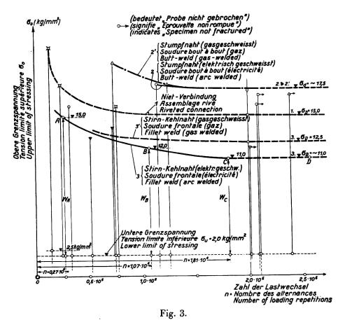
Lignes de Wöhler des essais du comité spécial avec assemblages de poutres rivés et soudés, sollicités à la traction.
