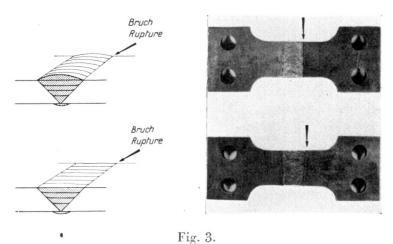
Rupture par fatigue dans la zone de transition de la soudure à la tôle.
