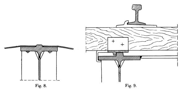
profilés en T ou en I pour raidir les hautes âmes. On peut renoncer à l'alternation des cordons lorsque l'épaisseur de l'âme est de plus de 16 mm. Afin de ne pas avoir une soudure sur le cordon de gorge, on coupe les angles intérieurs des raidisseurs. Dans la zone tendue on intercale de petites plaques d'appui fixées
