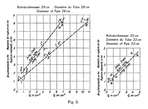
Au premier coup d'oeil on est frappé avant tout par la grande régularité (la faible dispersion) des résultats d'essai et non seulement dans les paires de poutres semblables mais aussi dans l'accroissement régulier des moments de rupture en fonction de l'augmentation de l'armature de traction.
