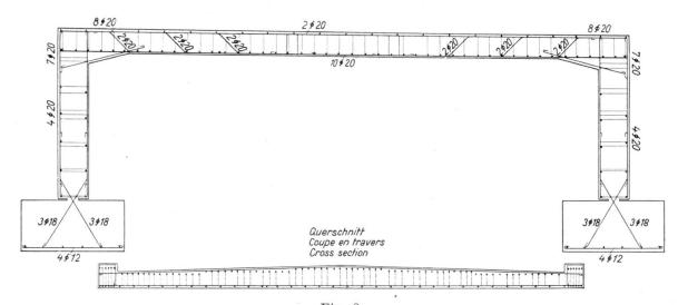
Fig. 6. Armature du cadre.
