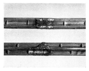
$\label{eq:Fig. 4.} \mbox{Fig. 4.} \\ \mbox{Barres } \mbox{$\mbox{$\scriptscriptstyle \times$}$} \mbox{Roxor} \mbox{$\mbox{$\scriptscriptstyle \times$}$} \mbox{soudées.}$
