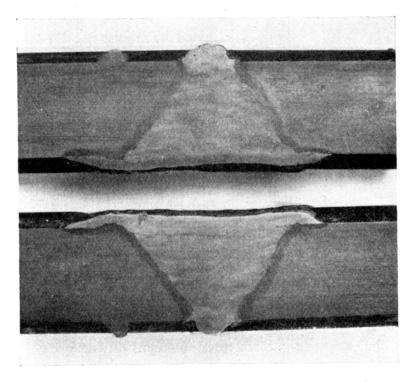
Fig. 7. Coupe longitudinale d'une barre «Roxor» soudée.
