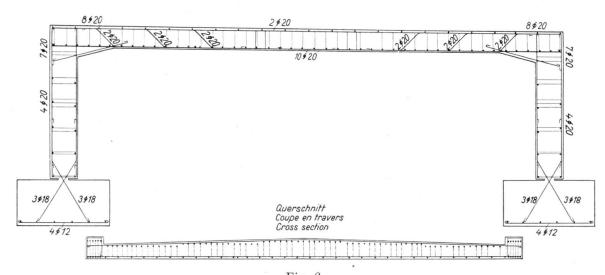
Fig. 6. Armature du cadre.
