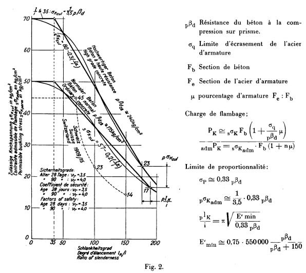
Colonnes de béton non fretté, armature longitudinale  $\mu\cong 1^{\,0}/_{0}$ . Contraintes de flambage admissibles au centre de gravité.  ${}_{8}\sigma_{K_{\mbox{adm}}}$  pour m=0. Béton normal et à haute résistance.
