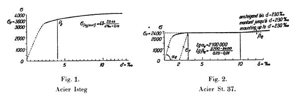
A l'appui de cette proposition on peut indiquer un fait important tiré de la continuité de la courbe des contraintes-allongements pour les aciers étirés et qui, suivant la proposition d'un collaborateur de *Klockner* (Prague), est représenté par une hyperbole reliée à la droite de *Hook* (fig. 1). La fig. 2 représente cette
