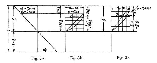
ligne pour l'acier ordinaire de construction. Nous avons représenté, pour le béton, à la fig. 3a l'allongement en admettant la planéité de la section; la fig. 3b donne la courbe des contraintes-allongements d'allure parabolique avec accroissement de l'allongement jusqu'au bord comprimé, sans augmentation de contrainte dans ce bord; à la fig. 3c nous avons représenté les allongements pour une répartition parabolique des contraintes-allongements.
