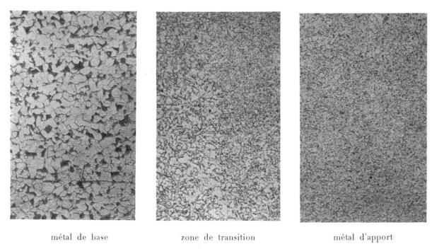
Fig. 8. Structure d'une barre «Roxor» soudée, agrandissement de 100 fois.
