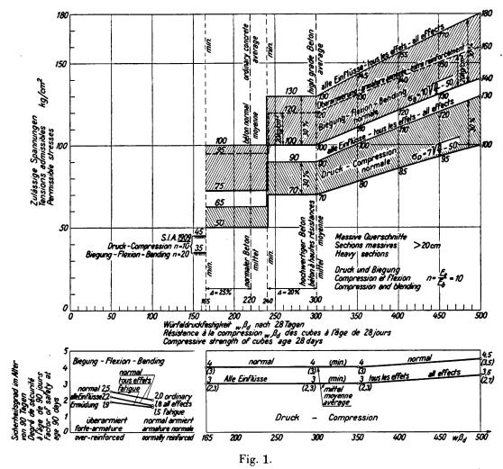
Prescriptions suisses du 14 mai 1935 concernant le béton armé. Tensions admissibles du béton et de l'acier d'armature en fonction de la résistance du béton à la compression et de la limite d'étirement de l'acier.
