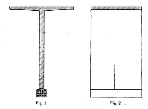
que le <sup>1</sup>/<sub>5</sub> de la résistance du béton à la compression; faute de quoi, il faut prendre toutes dispositions spéciales contre les fissurations dangereuses. Cette prescription est essentielle; il est à souhaiter qu'elle soit appliquée également ou dans des conditions semblables aux éléments de halls et à toutes les autres réalisations de la construction des charpentes en béton armé.
