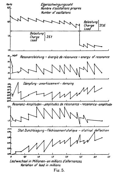
Essai de fatigue: Variation au cours de l'essai de différentes valeurs dynamiques.
