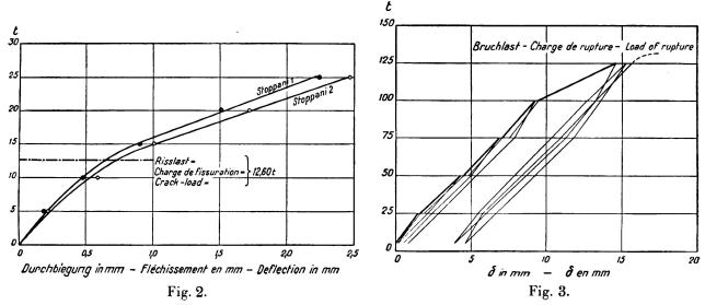
Détermination de la charge de fissuration.
