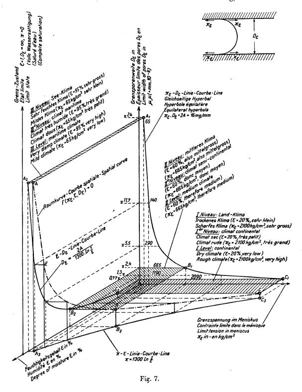
Le retrait total se compose donc d'un facteur hydro-élastique a  $=\frac{\omega_m}{E_1}$  et d'un
