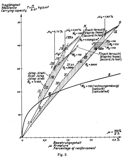
La résistance des poutres de béton armé à section rectangulaire, en fonction de l'armature d'après les essais de Dresde.
