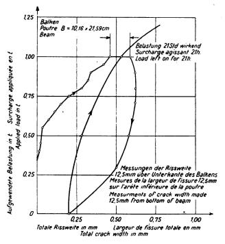
Fig. 5.Mesure de la largeur de fissure de F. G. Thomas.
