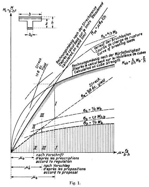
La résistance des poutres de béton armé en fonction de l'armature (d'après Emperger et Haberkalt).
