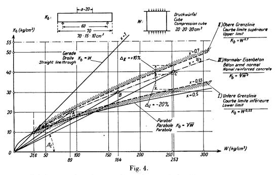
Relation entre la résistance à la traction par flexion  $K_b$  et la résistance à la compression W du béton:  $K_b = W^x$ .
