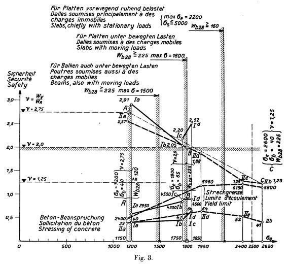
Résultats des essais à la fatigue effectués à Stuttgart sur des dalles avec armatures en Isteg et en treillis d'acier (I et II).
