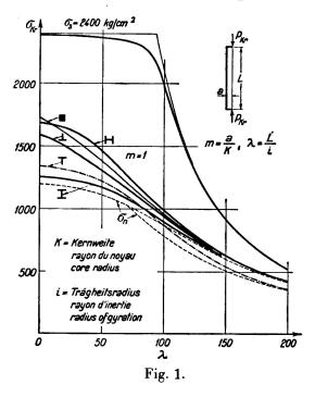
deux derniers cas, la contrainte critique se trouve très peu au dessus de la contrainte limite  $\sigma_n$  du domaine élastique. La courbe des contraintes critiques (courbe de  $\sigma_K$ ) pour m=0.01 est à peu près indépendante de la forme de la section et montre clairement, pour des barres dont le degré d'élancement est moyen, la forte influence, sur la résistance, d'une excentricité extrêmement petite de  $^1/_{100}$  du rayon du noyau central.
