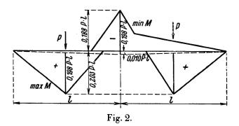
osé dépasser la limite d'écoulement dans la détermination de P, mais d'environ 2,5 % seulement car, dans les deux cas de charge, l'égalisation des moments est à peu près naturelle.
