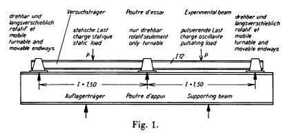
Disposition de l'essai.
