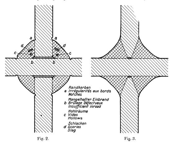
Die Hilfsmittel zur Prüfung der Güte der Schweißnähte sind wesentlich verbessert worden. Die Geräte zur Durchstrahlung der Schweißverbindungen sind leistungsfähiger und billiger geworden. Damit ist es möglich geworden, für hochbeanspruchte wichtige Stumpfnähte zu verlangen, daß sie vor der Ablieferung durchstrahlt werden.<sup>4</sup>
