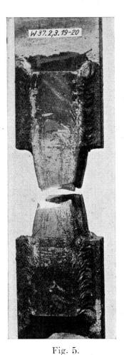
Verbindung mit Flankenkehlnähten nach dem Zerreißversuch (Abmessungen vor dem Versuch wie bei Fig. 4).
