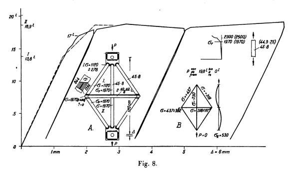
statiques, à savoir, des poutres soudées et des poutres rivées alors que G. Grüning et E.  $Kohl^{17}$  ont exécuté leurs essais sur des poutres extérieurement hyperstatiques. Les barres tendues les plus sollicitées étaient des barres à oeillets; ces essais ne permettaient donc pas de tirer des conclusions pour les assemblages ordinaires dans les noeuds. La forme des poutres d'essai, avec leurs dimen-
