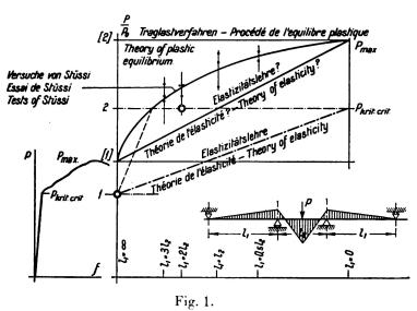
même dans les cas extrêmes, la charge limite (et non pas la vraie charge supportable) est double pour une poutre élastiquement encastrée. (Poutre simple sur deux appuis  $P_{T'}=1,71$  t;  $P_v=2,35$  t; poutre continue l=120-60-120,  $P_{T'}=3,46$  t;  $P_v=3,82$  t;  $P_{T'}=$  charge limite,  $P_v=$  charge supportable;
