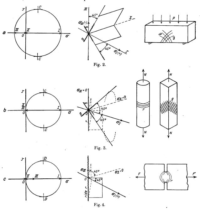
Fig. 2—4. Aspects des réseaux g ou des rides r de glissement apparaissant sur les faces extérieures des pièces, dans les parties en état plan de tension.
