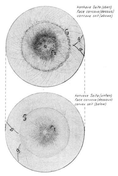
Fig. 7. Tôle d'acier ayant été déformée par l'application d'un poinçon.
