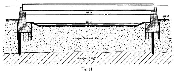
4° — Ouvrage W 26, au km 48,425, Direction Principale de Halle. Arc encastré (ponceau voûté), fondation en faible profondeur sur limon argileux peu résistant avec épaisseur de couche d'environ 1,50 m sur du sable. Pression sur le sol 2,75 kg/cm². Ouvrage complètement terminé en février 1936; affaisse-
