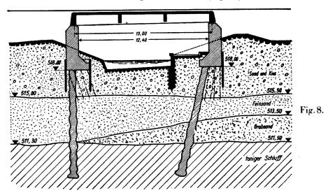
profondeur sur lit épais d'argile grasse (40 % 0,002 mm, teneur en eau à l'état naturel environ 31 %). Pression moyenne sur le sol 1,4 kg/cm² sous les culées et sous les piles. Ouvrage complètement terminé en juin 1935. Affaissements constatés jusqu'en avril 1936: maximum 54 mm pour les culées et 56 mm pour les piles. Affaissements prévus: 100 à 150 mm. L'ouvrage continue à s'affaisser; aucun dommage constaté.
