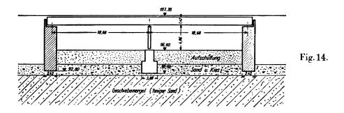
Ouvrage complètement terminé en décembre 1935; affaissement constaté jusqu'à avril 1936, environ 280 mm; l'affaissement de l'ouvrage continue.
