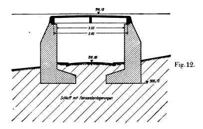
sur le sol de l'ordre de 1,1 kg/cm², sous-sol constitué par une argile sableuse de 8 à 10 m d'épaisseur, puis par du sable. Ouvrage complètement terminé en novembre 1935. Affaissement prévu environ 220 mm. Affaissement constaté 140 mm. Les affaissements continuent; aucun dommage.
