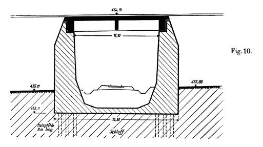
et 1 kg/cm² pour les piles. Ouvrage complètement terminé en août 1935, affaissement prèvu environ 150 mm pour les culées et 60 mm pour les piles. Affaissement constaté environ 46 mm pour les culées et 25 mm pour les piles; dernière mesure effectuée en août 1935. Les affaissements sont arrêtés; aucun dommage n'a été constaté.
