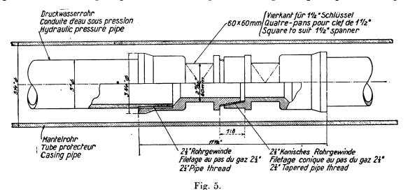
Joint de canalisation hydraulique sous pression.
