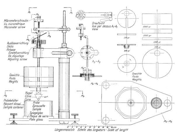
Fig. 9. Appareil d'essai à cône (détails).
